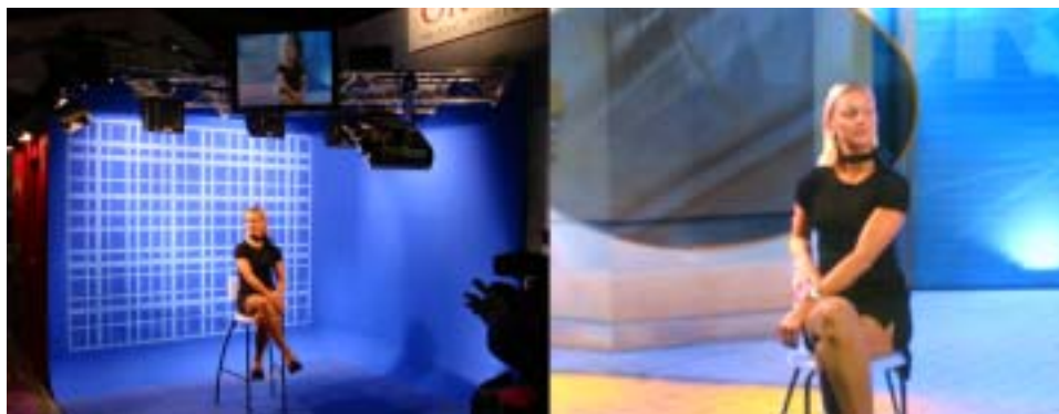
圖四：網格辨識系統在藍幕前的現場拍攝及節目播出畫面
